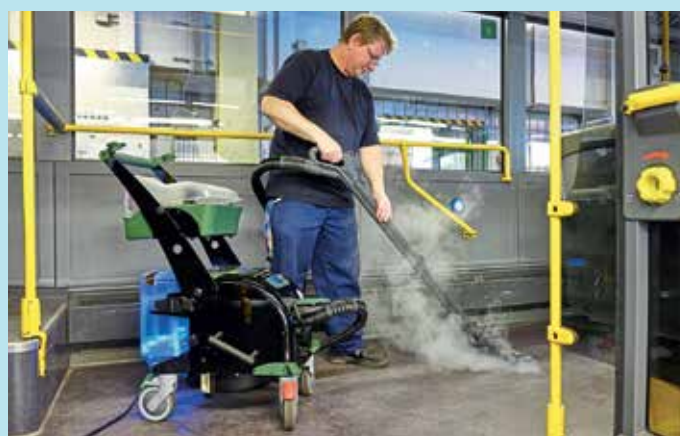
Da das System mit trockenem Dampf arbeitet, sind die gereinigten Flächen schnell wieder trocken.
