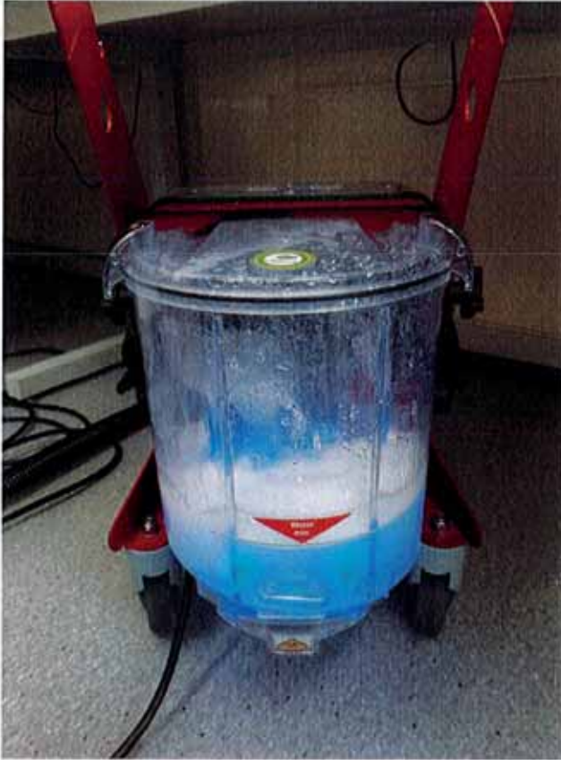
Abbildung 1: Dampfsauger BlueEvolution S+: Wassertank mit kontaminiertem Wasser während der Desinfektion.
