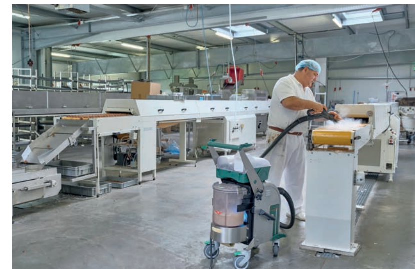
Das HACCP-zertifizierte Dampfsaugsystem Blue Evolution XL+ beseitigt bei der Confiserie Rau Allergen-Rückstände. The HACCP-certified Blue Evolution XL+ steam vacuum system removes allergen residues at the Confiserie Rau production facility.
