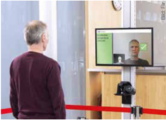
Die Flir-Screen-EST-Software dient der Verbesserung des Covid-19-Hauttemperatur-Screenings.
