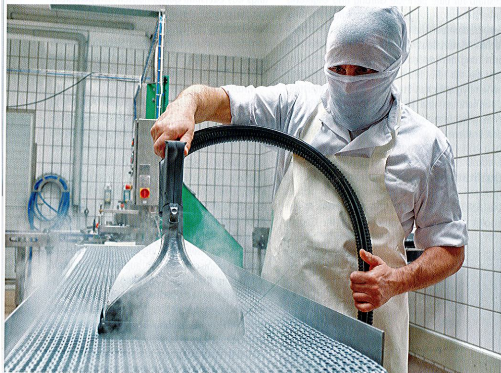
■ Abb. 1: Allein mit der Kraft des Trockendampfes kann die Trüffelmanufaktur Göschle verschiedenste Oberflächen gründlich von Schmutz, Keimen und Bakterien säubern. Dazu gehören z. B. empfindliche Arbeitsgeräte sowie Förderbänder.
